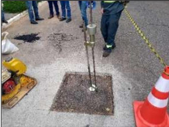
Teste de DCP efetuado. Resultados dentro das normas técnicas exigidas pela Sabesp
